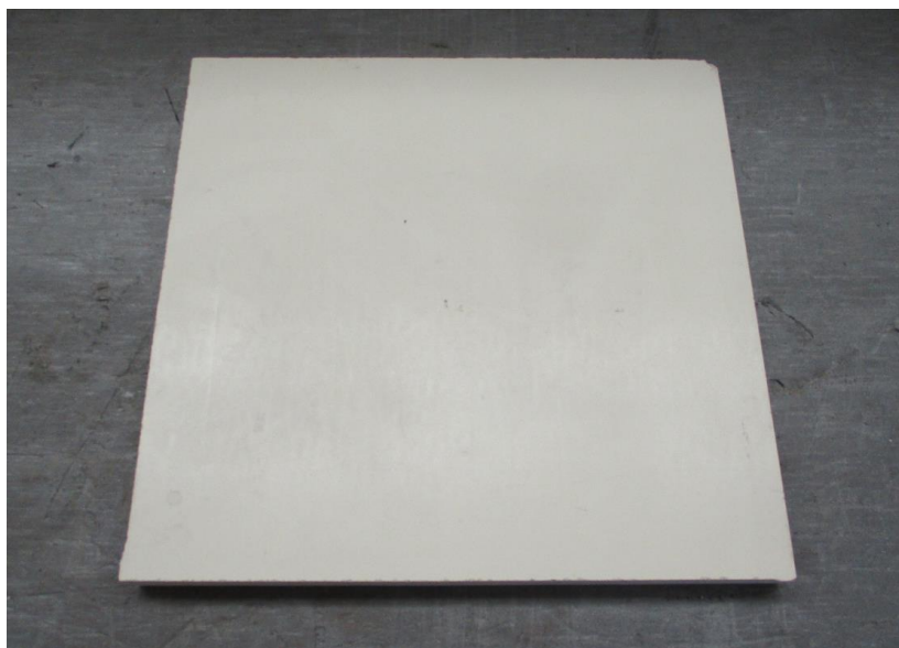
Figura 1. Riproduzione fotografica di uno dei 3 campioni (dimensioni 300 mm x 300 mm x 20 mm) del prodotto "Coprimuro in Marmoresina" fatti pervenire dal Committente.
