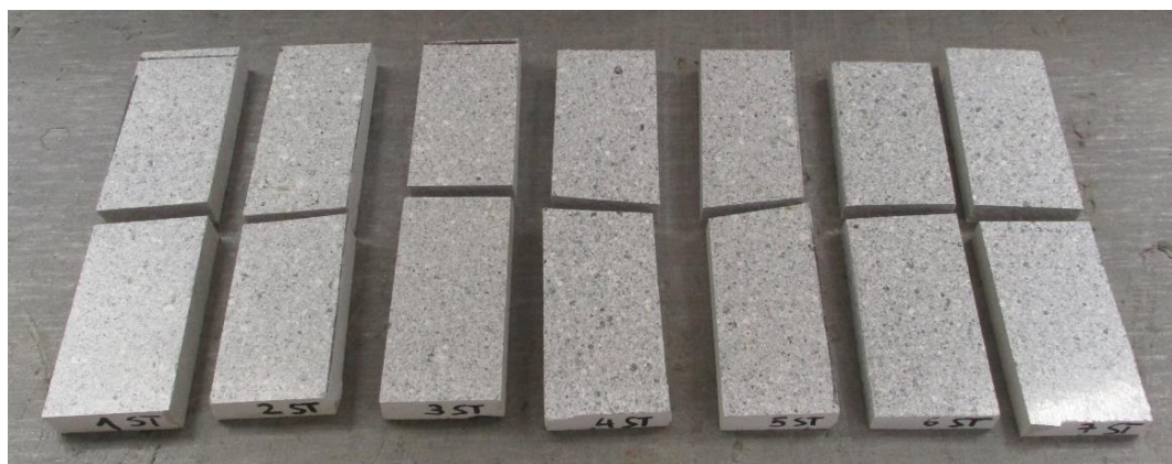
Figura 3. Campioni del prodotto “Coprimumo in Marmoresina” al termine della prova di determinazione della resistenza a flessione post cicli di sbalzi termici.
