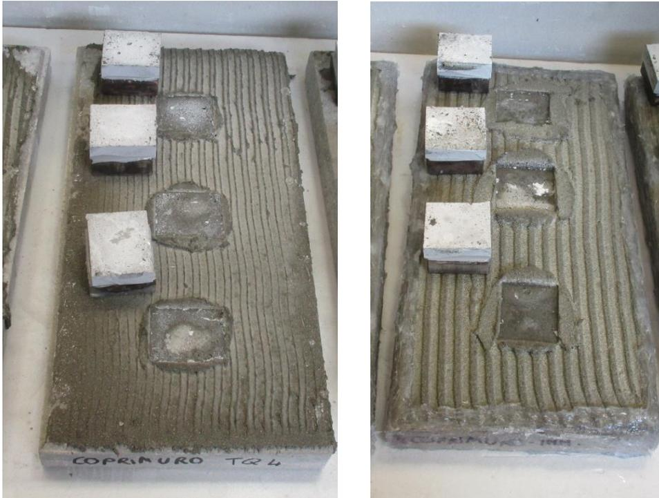
**Figura 3. Campioni risultanti dalle prove di adesione iniziale (sinistra) e dopo immersione in acqua (destra).**
