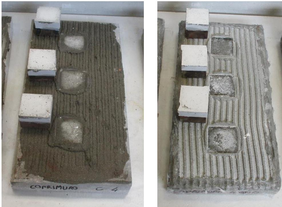
Figura 3. Campioni risultanti dalle prove di adesione dopo azione del calore (sinistra) e dopo cicli di Gelo/Disgelo (destra).
