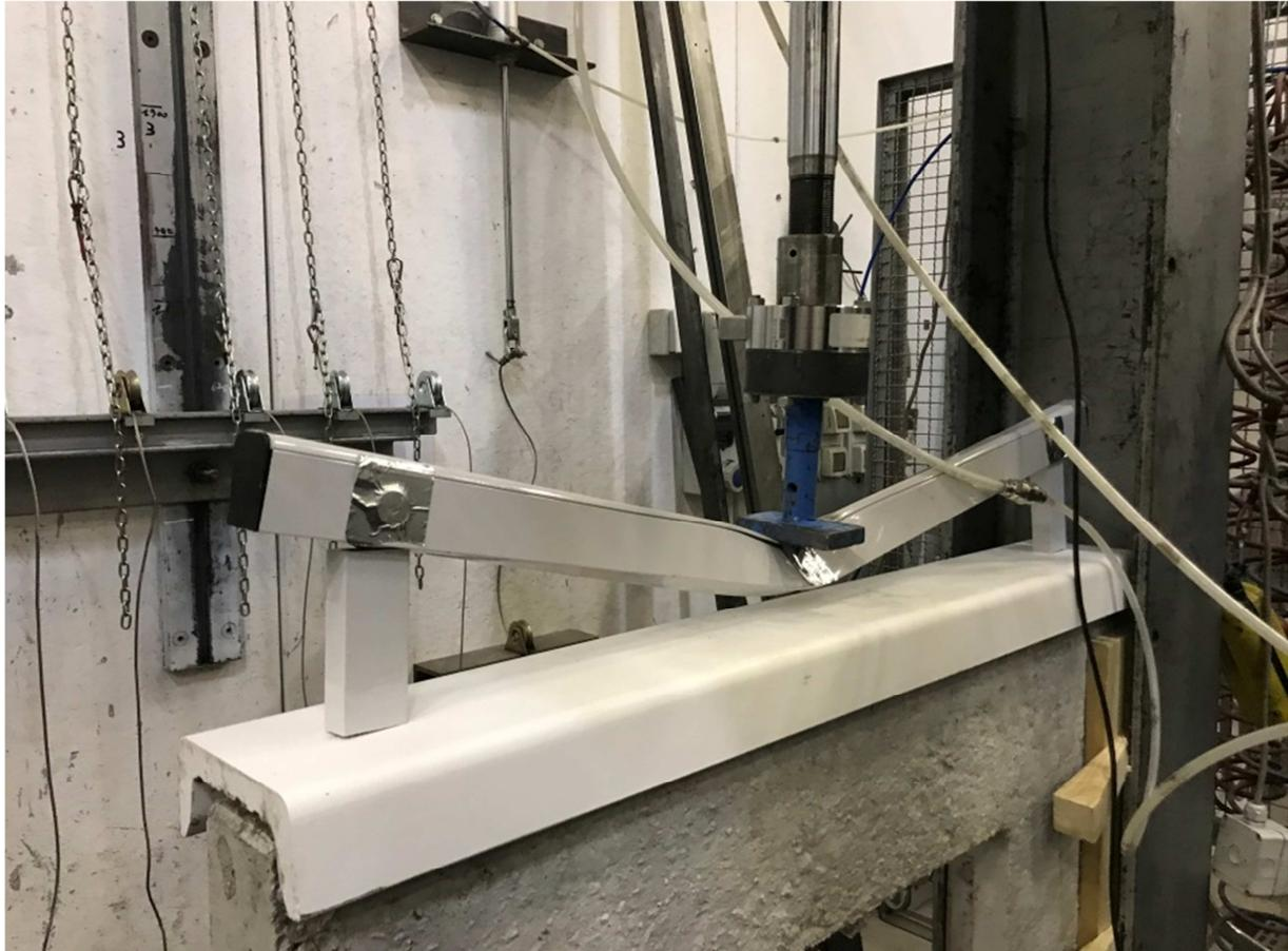
Fotografia dell'oggetto durante l'applicazione a rottura del carico verticale
